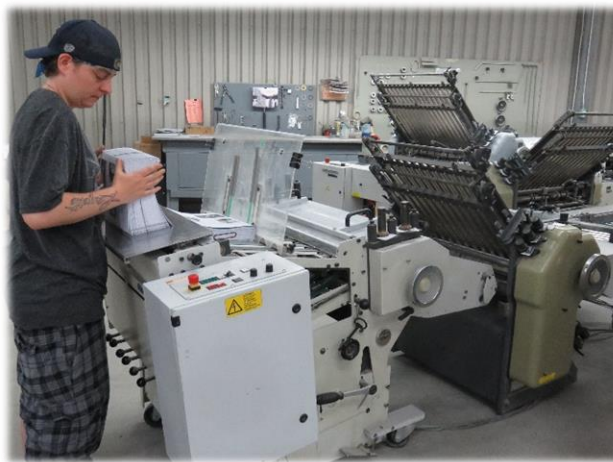
Une machine très sophistiquée, parmi tant d'autres, celle-ci sert au pliage des feuilles pour la fabrication des livres et autres.
